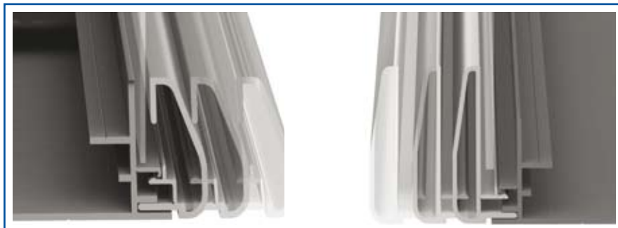
Séquence de simulation du clipsage
